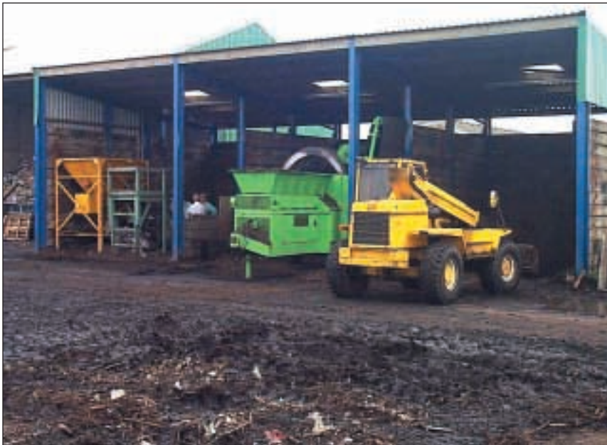
Πάνω Στέγαστρο που χρησιμοποιείται για το κοσκίνισμα και τη συσκευασία του εδαφοβελτιωτικού
