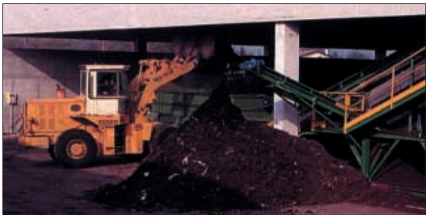
Πάνω Τελική αποθήκευση του εδαφοβελτιωτικού στη μονάδα
