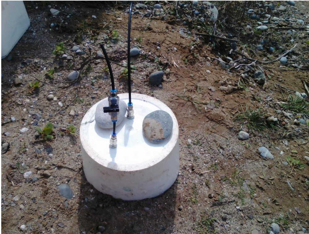
Εικόνα 2. Φωτογραφία του δοχείου για μέτρηση αερίων εκπομπών από το έδαφος.
